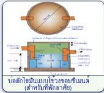
บอลดักไขมันแบบไขว่ของขอบซีเมนต์ (สำหรับที่พักอาศัย)
